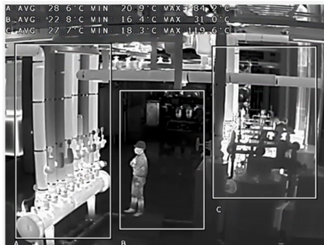
[17. attēls. Vidējās, maksimālās un minimālās temperatūras piemērs atkarībā no ROI apgabaliem]
