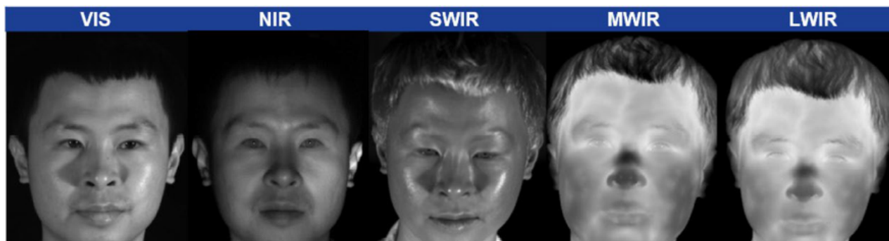
[2. attēls. Objekta attēla salīdzinājums redzamajā gaismā un infrasarkanā starojumā]
