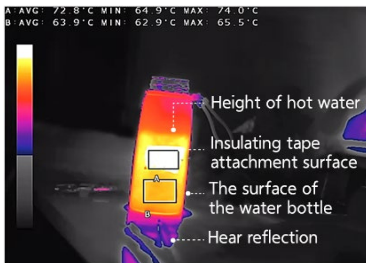
[21. attēls. Termiskā attēla atšķirība atkarībā no izstarojuma, uzpildot karstu ūdeni pudelē]
