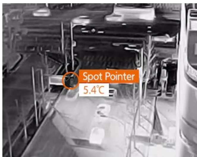
[18. attēls. Temperatūras kontrole, izmantojot punkta rādītāju]
