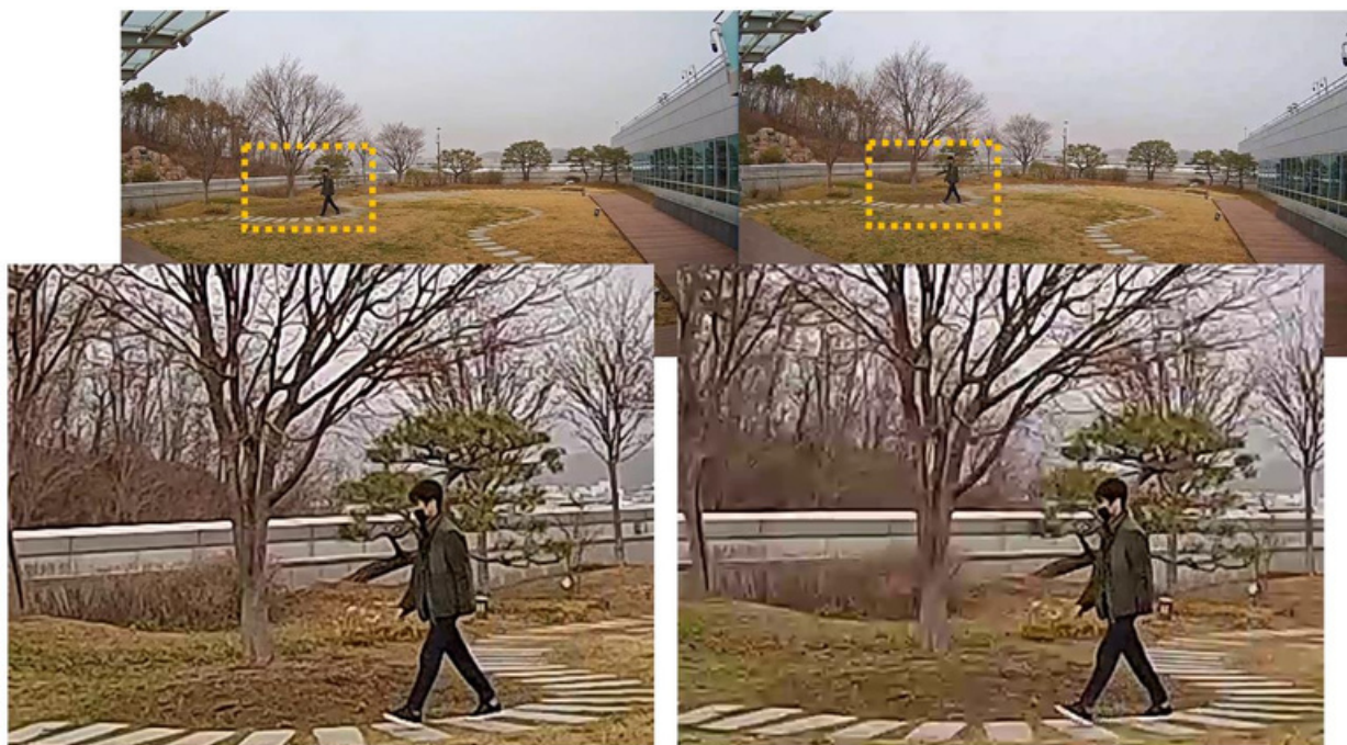
2. attēls. WiseStreamIII režīms. Pa kreisi - izslēgts, pa labi – augsts.
